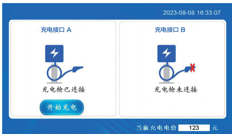
图 6 充电枪（A 枪）已连接
