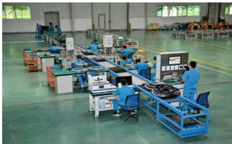
充电枪线生产线
